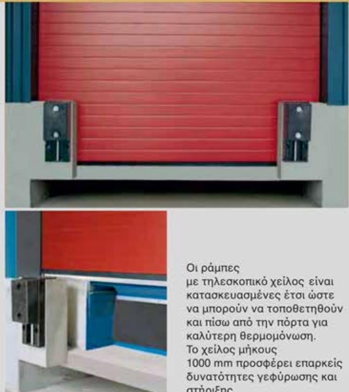
Οι υδραυλικές ράμπες HTL-2 με τηλεσκοπικό χείλος είναι κατασκευασμένες έτσι ώστε να μπορούν να τοποθετηθούν και πίσω από την πόρτα για καλύτερη θερμομόνωση. Το χείλος μήκους 1000 mm προσφέρει επαρκείς δυνατότητες γεφύρωσης και στήριξης.
